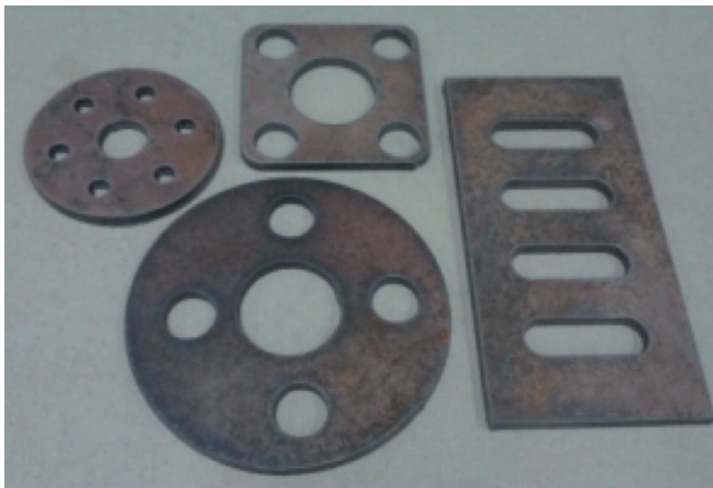
Fig.11: Algunas piezas cortadas por plasma con la máquina operando con la nueva arquitectura
