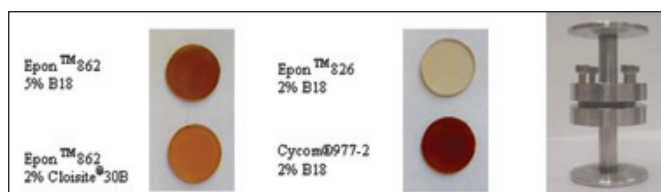
Figura 1. Nanocompuesto arcilla/epoxi y detalle del soporte para la medida de permeabilidad al helio
