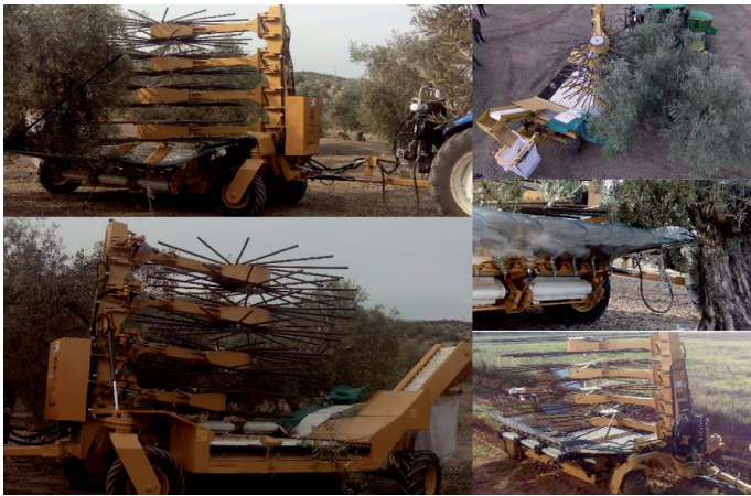
Fig. 8: Prototipo cosechadora recolectando un olivo tradicional
