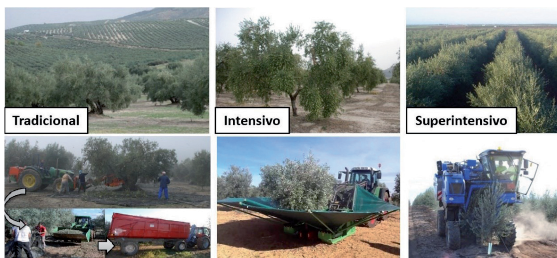
Fig. 1: Tipologías de olivar (arriba) y sistemas de recolección utilizados (abajo). De izquierda a derecha: vibrador de troncos con vareo, manejo de lienzos; vibrador de troncos con paraguas; cosechadora cabalgante con gestión de fruto
