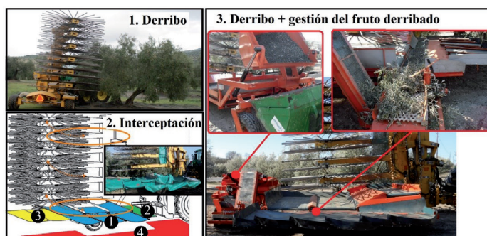
Fig. 5. Etapas de la fase 3 utilizando el sacudidor Oxbo 3210
