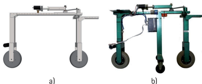
Fig. 2. a) Modelo en Solidworks® del prototipo; b) Aspecto final del prototipo experimental
