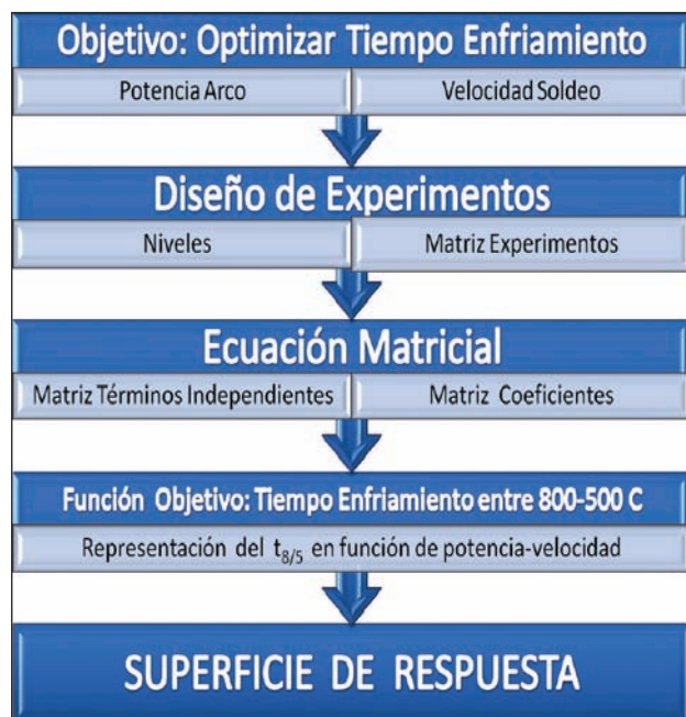
Aplicación del método de Superficie de Respuesta al cálculo tiempo del enfriamiento
