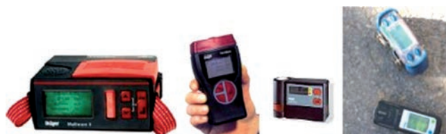
Fig. 5: Equipos medidores de gases
