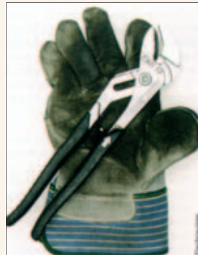
Fig. 13. Los guantes de cuero no protegen contra la tensión. La pinza no es aislante.
