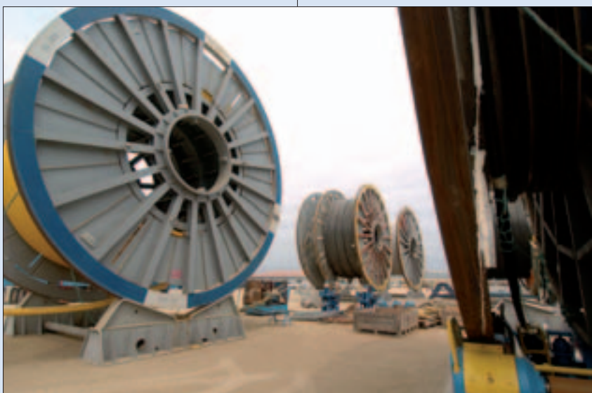
Fig. 8. Fabricación del cordón umbilical en la planta de Angloflex , Lobito, Angola
