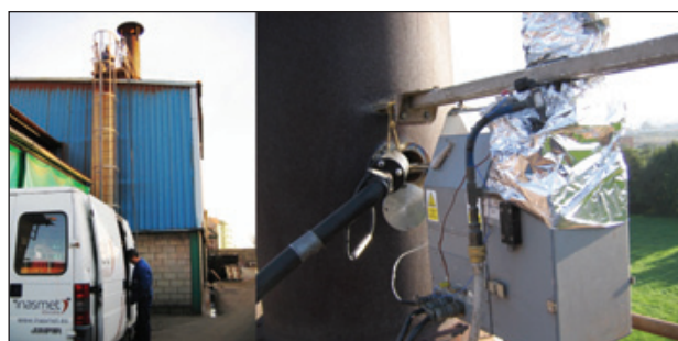
Equipo muestreando en chimenea. Fuente: INASMET
