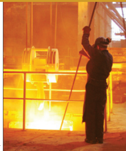
Operaciones de desescoriado en horno de arco. Fuente: INASMET
