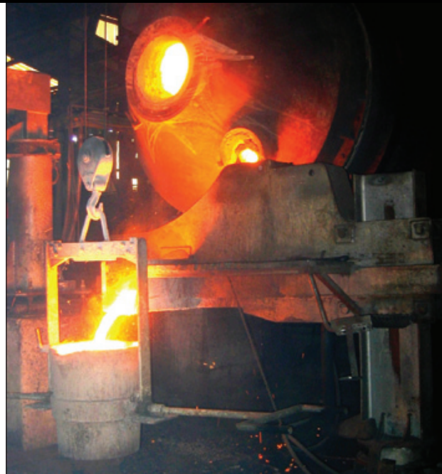
Imagen de un proceso habitual de fundición, sangrado del horno. Fuente: INASMET
