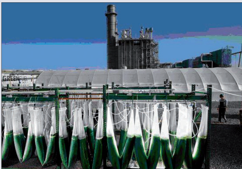
Bolsas de algas alimentadas con CO 2 bombeado desde la central eléctrica cercana
