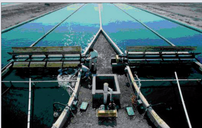
En el sistema de estanques abiertos, las paletas mueven las algas por la canalización a fin de exponerlas a la luz solar
