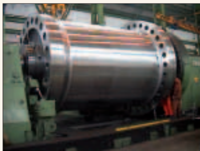
Fig. 8: Mecanizado final del eje.
