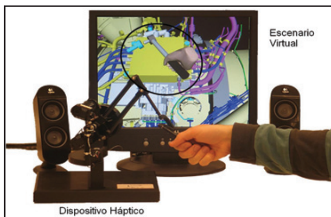
Fig. 2: Sistema háptico con realimentación de fuerzas
