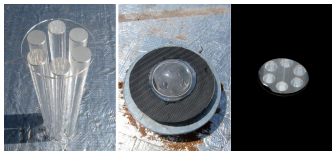
Figura 1: Prototipo 1. Izquierda, núcleo de barras acrílicas; Centro, cúpula exterior, Derecha, zona de emisión de luz
