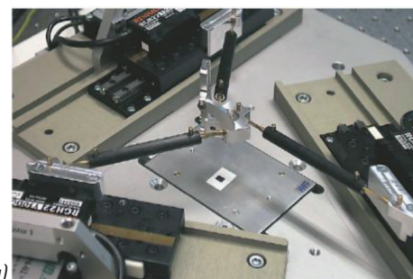
Fig. 14: Robots miniatura de arquitectura paralela: (a) APIS y (b) MICABO. Instituto Tecnológico IWF de la Universidad de Braunschweig, Alemania
