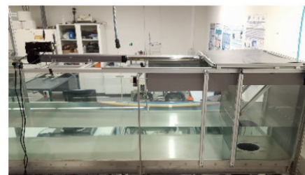
Fig. 1: Parte superior: Vista general del COE. Parte inferior (de izquierda a derecha): sistema de extinción de perfil parabólico, sensores de ultrasonido y sistema de generación de ola de tipo pistón
