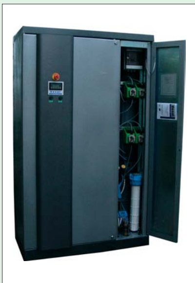
Capacidad: 28 m 3 /día Funcionamiento totalmente automatizado prêt à porter, con pretratamientos. Prototipo industrial instalado en Almería.
