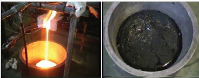
Fig. 5: Vaciado de material fundido y producto final vitrificado
