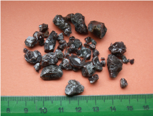
Fig. 7: Material vitrificado granular
