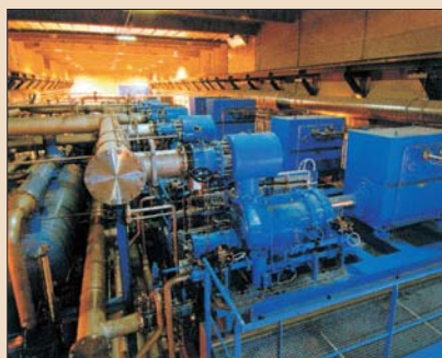
Cada uno de los ocho refrigeradores de 4,5 K para el LHC consta de una estación compresora (izquierda), y una cámara fría (Air Liquide, centro; Linde, derecha)
