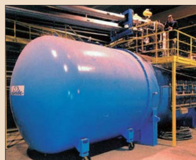
Cada uno de los ocho refrigeradores de 4,5 K para el LHC consta de una estación compresora (izquierda), y una cámara fría (Air Liquide, centro; Linde, derecha)
