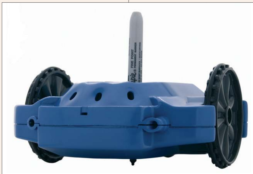
Figura 6.- El Scribbler utiliza un rotulador para dibujar todo tipo de figuras.
