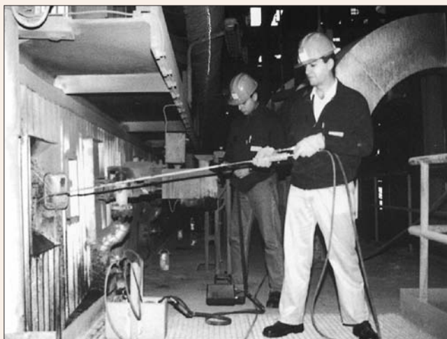
Fotografía 1: Muestreo manual con Sistema OPTICOM para caracterización de gases en proximidades de quemadores
