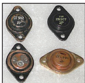
Fig. 3: Primeros transistores bipolares de potencia de germanio en cápsula TO-3 de Sylvania, 1956. Alcanzaban varios amperios y decenas de voltios. Cortesía J. A. Knight.
