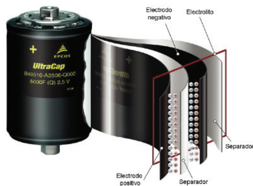
Fig. 8: Supercondensador electrolítico, o de doble capa, de elevada capacidad. Suplantando a las baterías rápidas para tiempos de descarga inferiores a 1 minuto. Cortesía de EPCOS.
