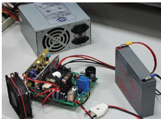
Fig. 13: Prototipo de fuente de alimentación de 208 W y 6 salidas para ordenador, que opera también como SAI de c.c. con 7 min. de autonomía en ausencia de red [16].
