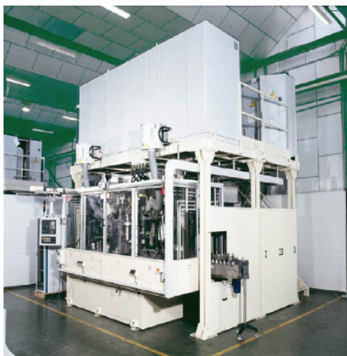
Fig. 6: Instalación llave en mano para temple de juntas homocinéticas. Cortesía de GH Electrotermia, Valencia, España
