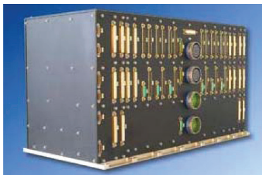
Fig. 12: Unidad de control y distribución de potencia del satélite GOCE, ESA, realizada en Crisa, España
