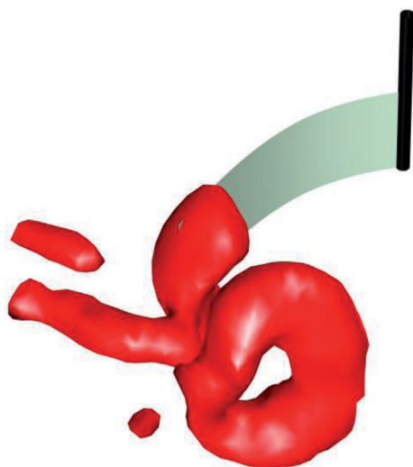
Fig. 3: Estela aguas abajo de una lámina flexible utilizada para simular el nado ondulatorio. La lámina es actuada por un motor que impone una señal senoidal de posición angular en su canto de ataque. Las estructuras que aparecen son isosuperficies de vorticidad (criterio Q) derivadas de medidas realizadas mediante el uso de velocimetría volumétrica o DDPV (Huera-Huarte et al., 2015)
