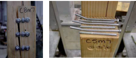
Figura 6: Unión con clavijas y elementos tuerca-arandela
