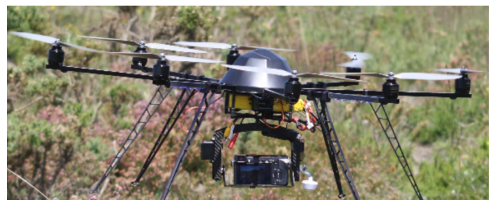
Figura 2. Oktokopter XL equipado con la cámara Sony NEX7. La antena blanca pertenece al GPS usado para control del vuelo
