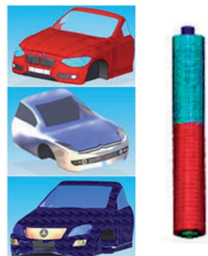
Fig. 2: Modelos de vehículo e impactador de pierna utilizados
