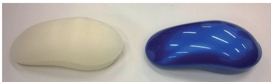
Fig. 3: Carcasa de ratón fabricada con tecnología aditiva. A la izquierda resultado de la tecnología aditiva. A la derecha mismo elemento sometido a postproceso.
