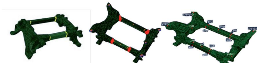
Fig. 5: Modelado del conjunto chasis para las simulaciones CAE: desde el lado izquierdo, nodo con restricciones "tie", tensiones residuales iniciales y grados de libertad restringidos
