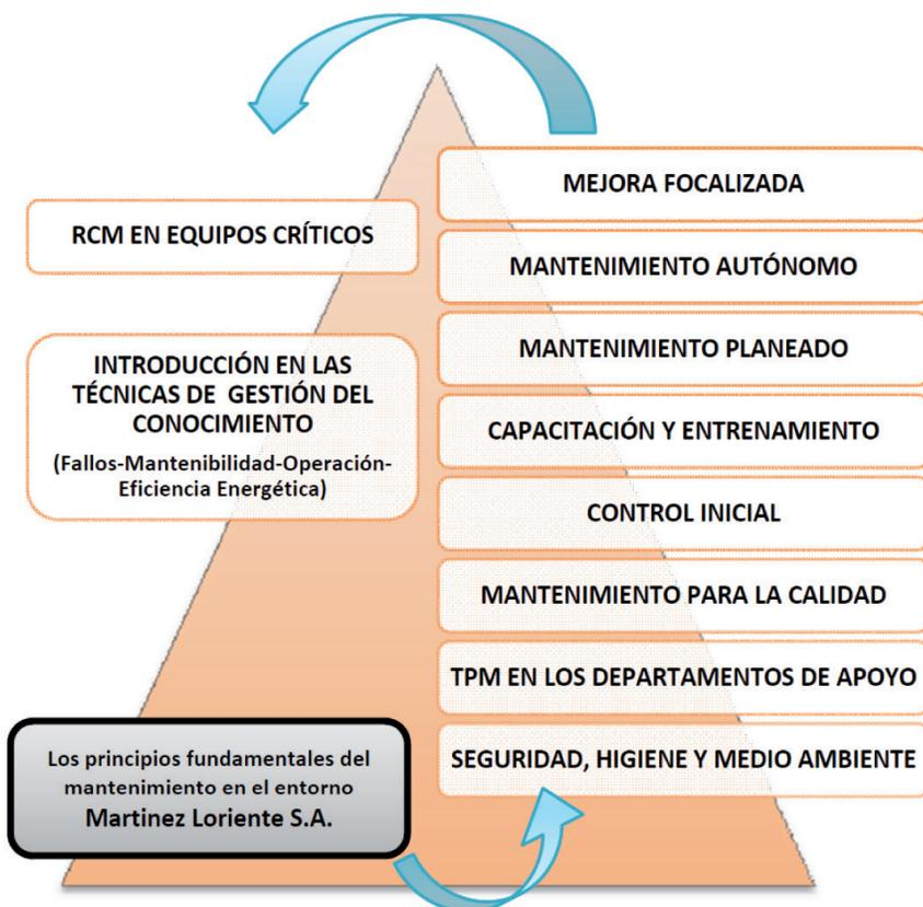
Figura 4: Principios de mantenimiento en las factorías de Martínez Lorient S.A.
