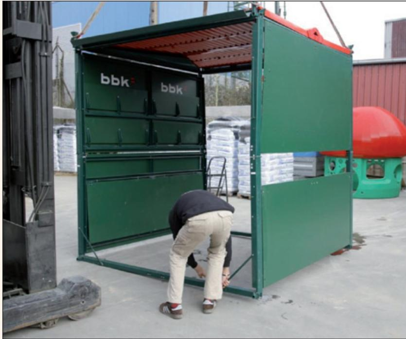
En es momento se despliegan los tensores para rigidizar la estructura
