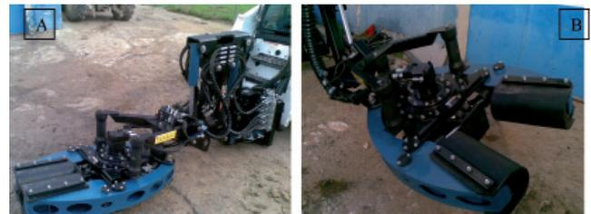
Figura 14: Imagen de la pinza vibradora prototipo. A) Posición cerrada. B) Posición abierta
