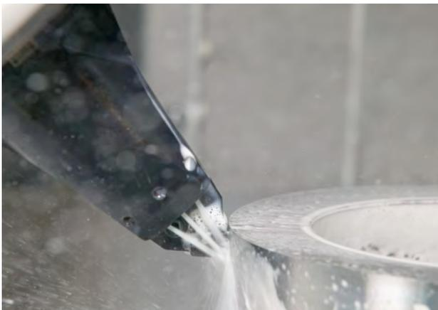
CoroTurn HP para materiales HRSA con dispositivo refrigerante
