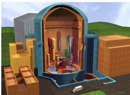
Fig. 9: Esquema general de un reactor EPR
