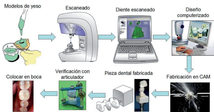
Fig. 1: Proceso en un sistema CAD/CAM dental general
