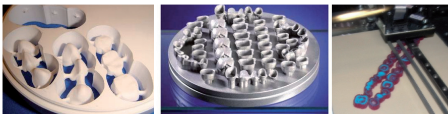
Fig.5: Restauraciones dentales. A: por sustracción de material. B: por sinterizado selectivo por láser de una aleación en polvo. C: prototipado rápido
