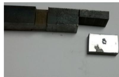
**Caso 3. Probetas con la inducción del efecto Bauschinger y sin tensiones residuales**
