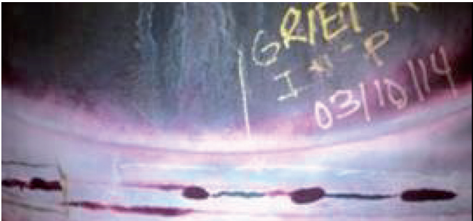
Figura 12.Resultado de ensayo de líquidos penetrantes en tubería
