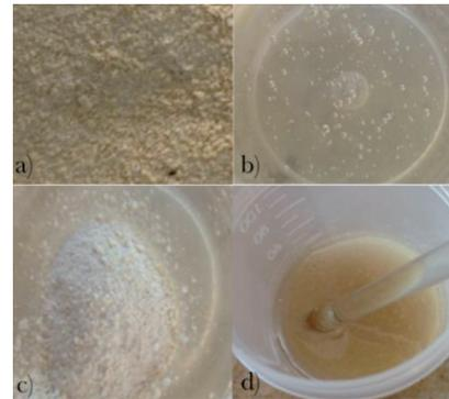
Fig. 1: Mezcla de resina-hueso-hidroxiapatita
