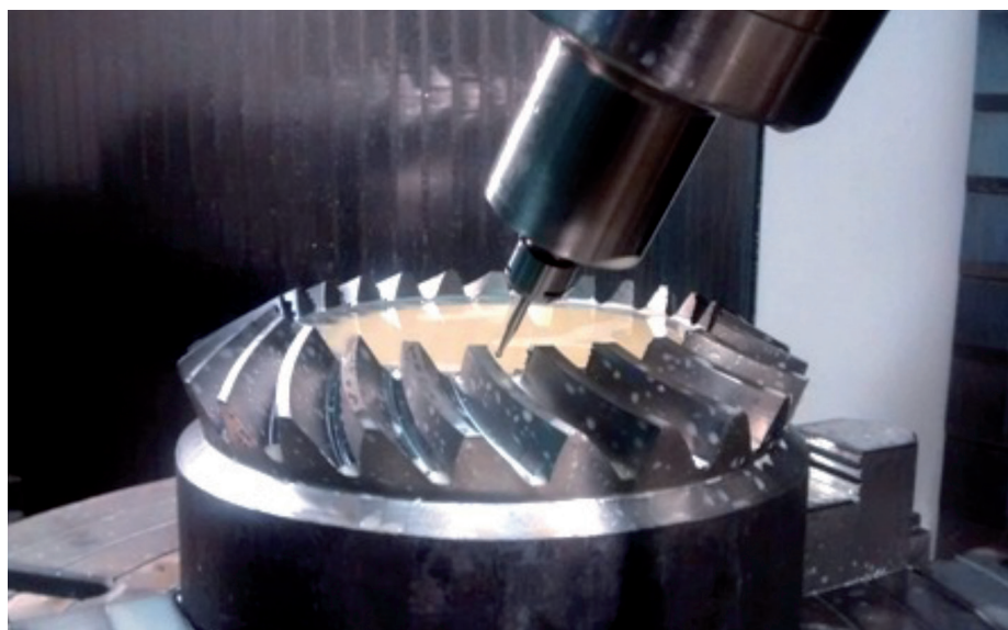
Fig.4: Mecanizado de engranaje con herramienta genérica realizado por el Grupo de Mecanizado de Alto Rendimiento de la UPV/EHU
