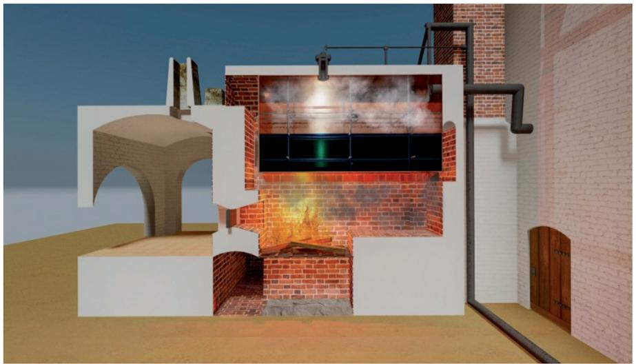
Fig. 2: Sección reconstrucción virtual de las calderas de la primera máquina de vapor
