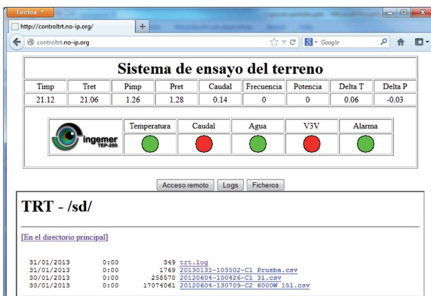
Fig. 9: Página web para la monitorización remota a través de Internet antes del inicio del ensayo
