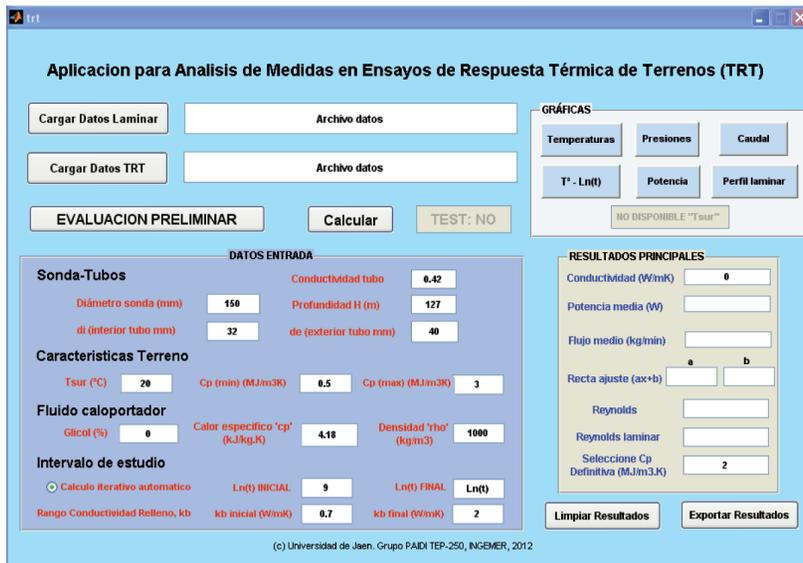
Fig. 5: Software para obtención del informe final del ensayo
