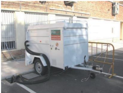
Fig. 2: Máquina TRT montada sobre remolque y conectada a sonda
