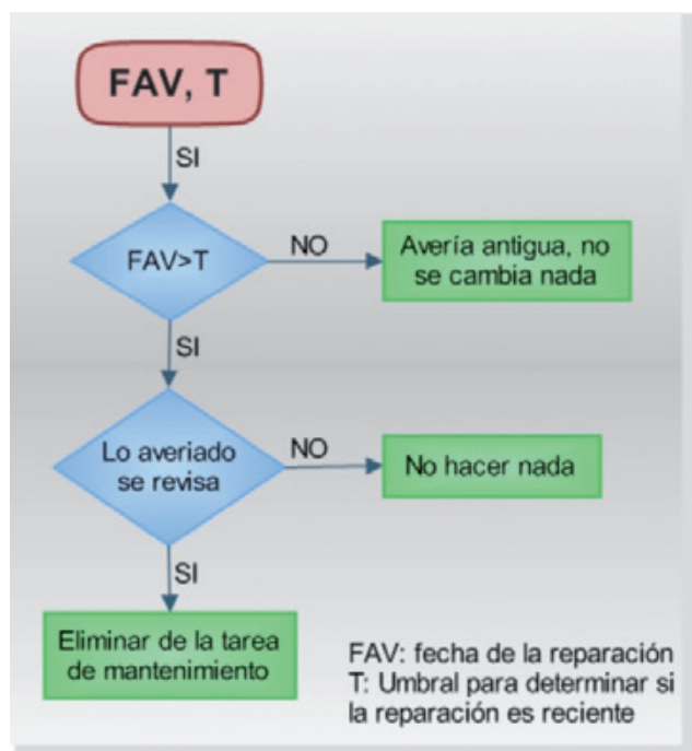
Fig. 2: Esquema de eliminación de tareas de mantenimiento utilizado por el módulo de recomendación
