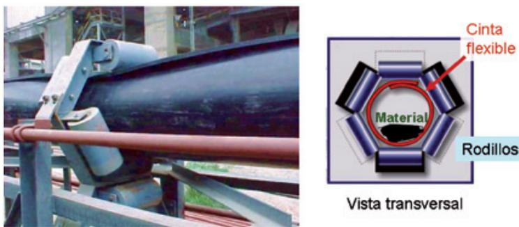
*Fig 6: esquema de funcionamiento una cinta tubular ("pipe conveyor")*
