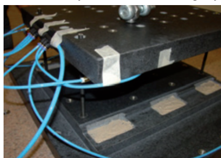
Fig. 4: Proceso de pegado utilizando vacío
