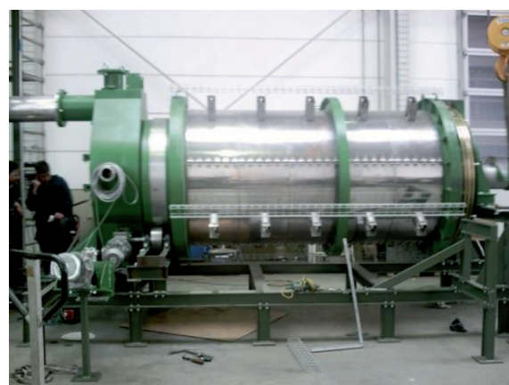
Fig. 3: Reactor de pirólisis-torrefacción (Fuente: InfinitVE)
