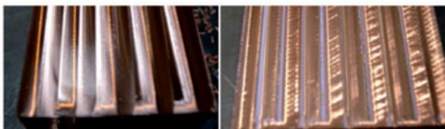
Fig. 9: Izq.) Superficie mecanizada con herramienta de HSS nueva. Dcha.) Superficie mecanizada con herramienta de HSS con un desgaste de 0,3mm.
