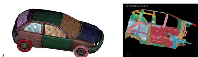
Figura 1: Modelo virtual de vehículo Geo Metro y mallado de elementos finitos
