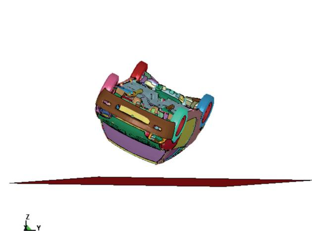
Figura 8: Posición del vehículo en ensayo de vuelco con distancia inicial
