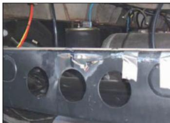
Detalle de la colocación de una galga del ensayo extensiométrico en el travesaño central de la suspensión
