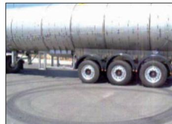
Ensayo de giro de radio mínimo
