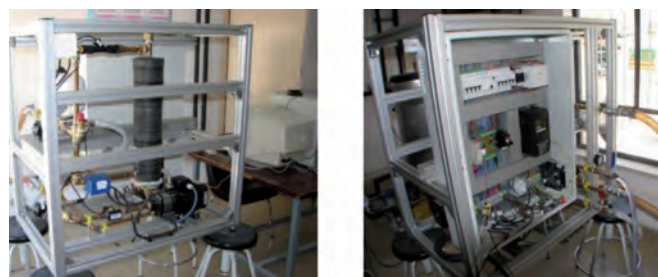
Fig. 3: Vistas anterior y posterior del equipo desarrollado mostrando circuitos hidráulico y eléctrico
