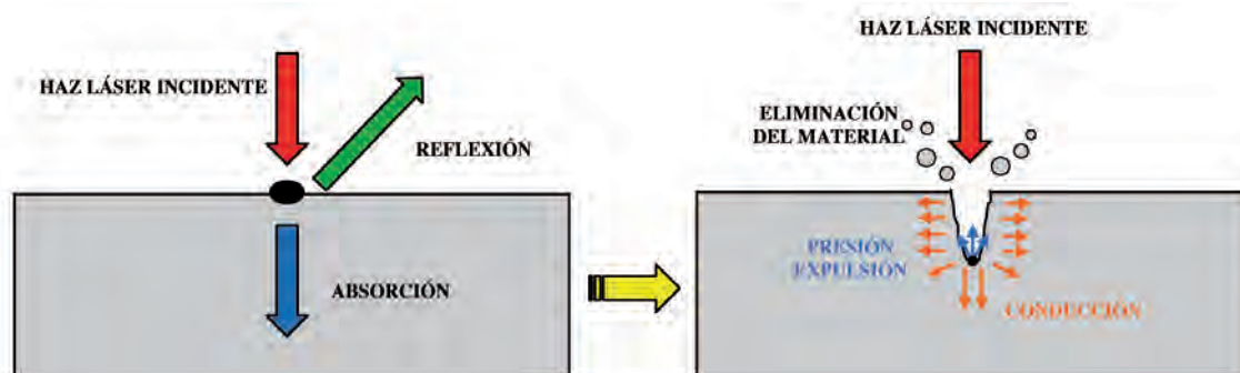
Figura 2: Proceso de taladrado láser
