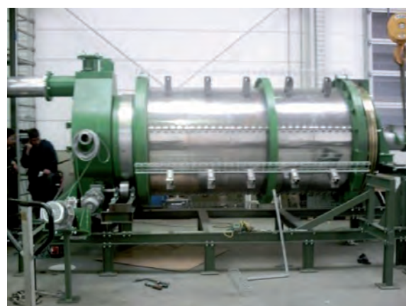
Fig. 3: Reactor de pirólisis-torrefacción (Fuente: InfinitVE)
