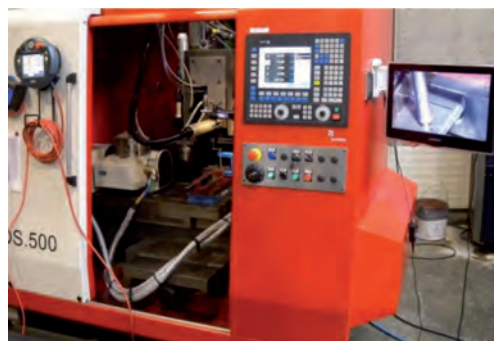
Figura 5: Centro de Mecanizado KondiaAktinos 500
