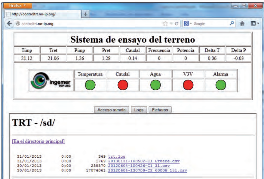
Fig. 9: Página web para la monitorización remota a través de Internet antes del inicio del ensayo
