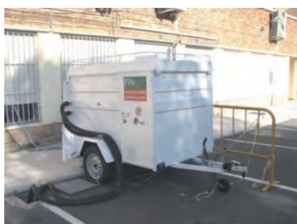
Fig. 2: Maquina TRT montada sobre remolque y conectada a sonda
