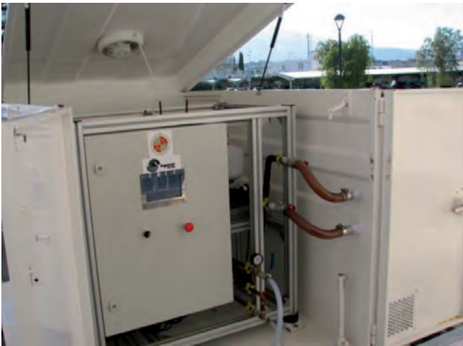
Fig. 8: Máquina TRT montada sobre remolque para su transporte
