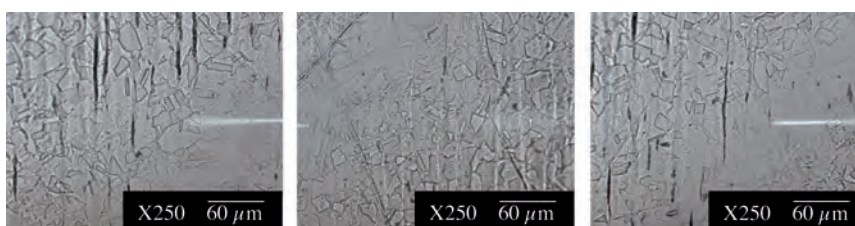
Fig. 6: Microfotografías x 250 de las estructuras escalonadas y dual en las probetas de Ø60mm
