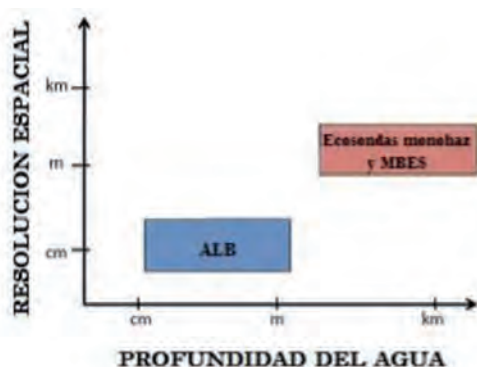
Fig. 3: Resolución espacial en función de la profundidad, para tecnologías ALB y ecosondas (monohaz y MBES)[10]
