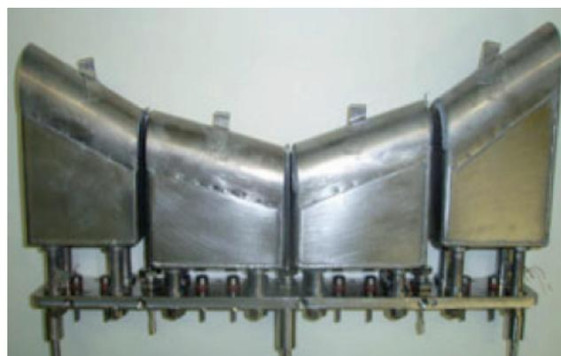
Cabeza de un limitador de litio líquido con el sistema CPS
