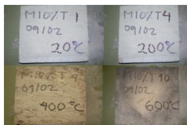
Fig. 8: Losas reforzadas con fibras tratadas químicamente al 10 % en volumen sometidas a altas temperaturas
